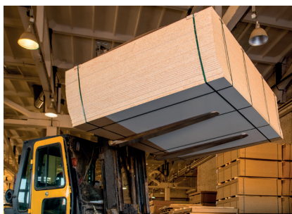
Schonende Ladungsaufnahme bei minimaler Einfahrhöhe
