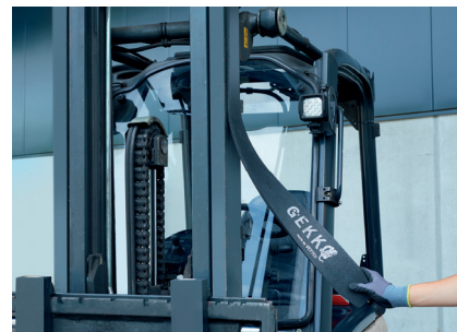
Bei Nichtgebrauch: Befestigung am Hubmast oder Chassis
