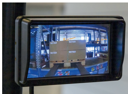
Monitoransicht im Fahrerhaus, Einbau am Gabelträger
