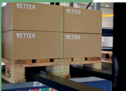
Präzises Anvisieren mittels Kreuzlaser
