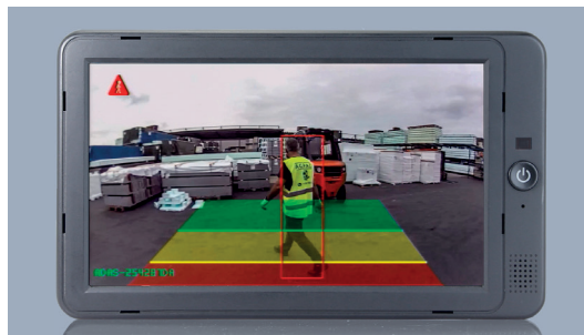
... Person hinter dem Stapler wird per Kamera erkannt
