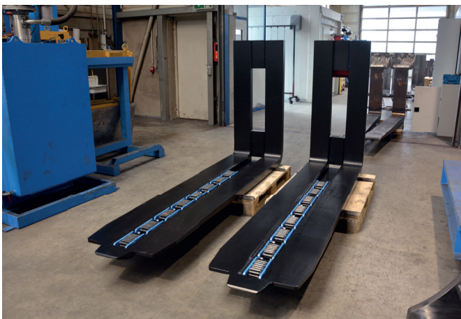
Gabelzinken mit integrierten Rollen im Gabelblatt für den Flughafen-Einsatz
